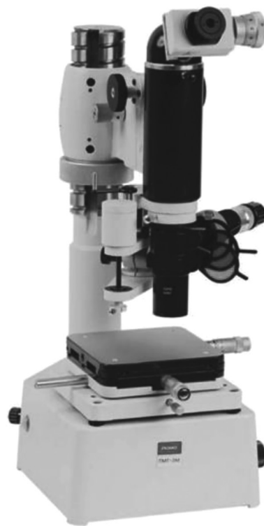
Рис. 6. Микротвердометр «ПМТ-3» фирмы «Ломо» (Россия)
