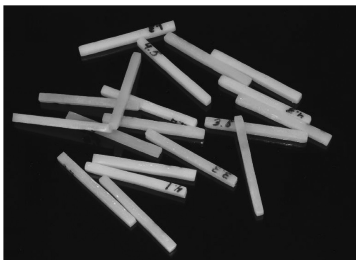
Рис. 3. Готовые образцы композитов для проведения исследования прочности на изгиб Fig. 3. Ready-made composite samples for studying the bending strength
